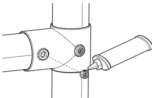
Auf jede Madenschraube muss vor dem endgültigen Festziehen Loctite aufgetragen werden
