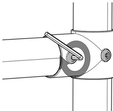
Die Madenschrauben werden mit einem Drehmoment von 40 Nm angezogen
