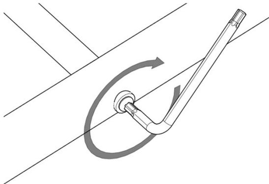
Die Schrauben der Sprossen werden so fest angezogen, dass die Sprossen nicht mehr wackeln und sich nicht mehr drehen können
